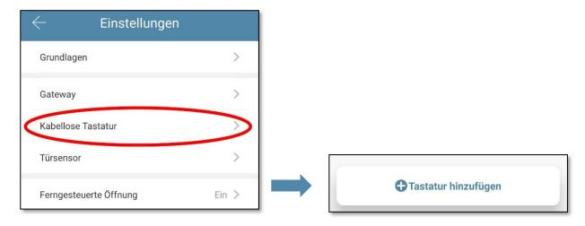
Damit die kabellose Tastatur vom Smartphone erkannt werden kann, muss zunächst der **Anlernmodus aktiviert** werden. Dies ist der Fall, wenn am Gerät die **LED** (rechts oben) **grün blinkt**.
