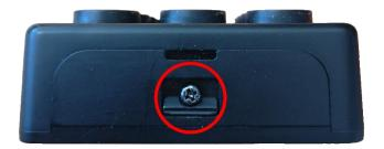
Anschließend können **4 x AAA – Batterien** eingelegt werden und das Batteriefach kann wieder hineingeschoben und festgeschraubt werden. Um die **Funktion des Geräts** zu **testen**, können Sie bei Tastendruck prüfen, ob die grüne Status-LED (rechts oben) blinkt.
